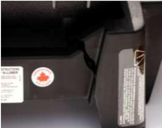
脚を固定する爪が破損しています。
